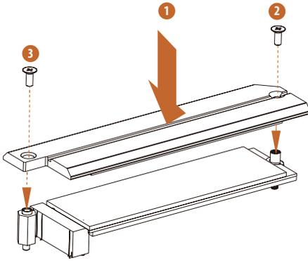
ドライバーでネジを締めてモジュールを固定し (M.2 SSD モジュールがタイプ 2280 の場合)、M.2 ヒートシンクを示されている順序で所定の位置に固定します。最初に M.2 コネクタの反対側のネジを締め (2)、次に M.2 コネクタの隣のネジを締めます (3)。
