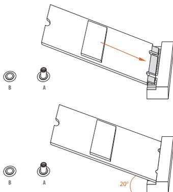
M.2 SSD モジュールを整列して、丁寧に M.2 スロットに挿入します。M.2 SSD モジュールは 1 方向にしか取り付けられません。
