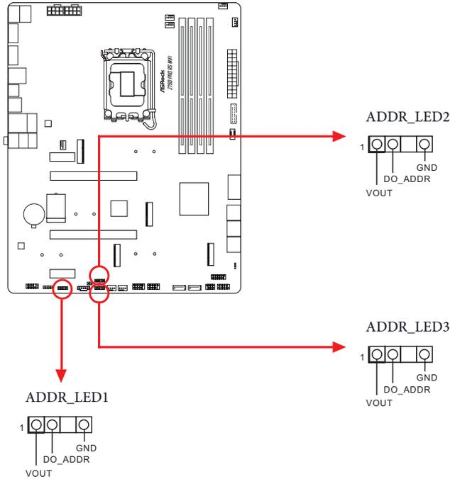
アドレスابل RGB LED ストリップをマザーボード上のアドレスابل LED ヘッダー (ADDR\_LED1 / ADDR\_LED2 / ADDR\_LED3) に接続します。
